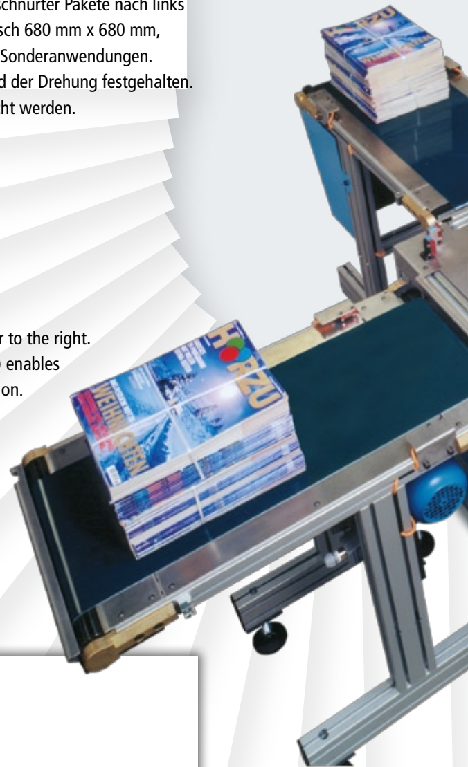
Funktion 3: Einlauf links – Auslauf rechts Function 3: Inlet left – outlet right
